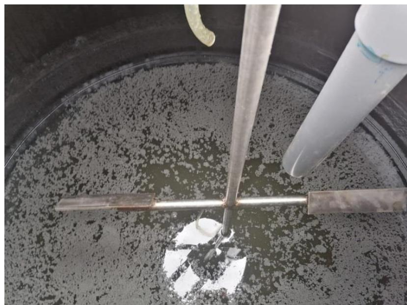
*Nota.* La imagen muestra el proceso de floculación en donde al finalizar el agua es retenida en las tolvas para se lleve a cabo la sedimentación de los flóculos.
