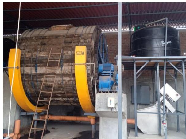
*Nota.* Imagen muestra los bananos situados en cada lado del botal para transportar el agua residual al filtro compactador
