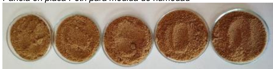
Panela en placa Petri para medida de humedad
