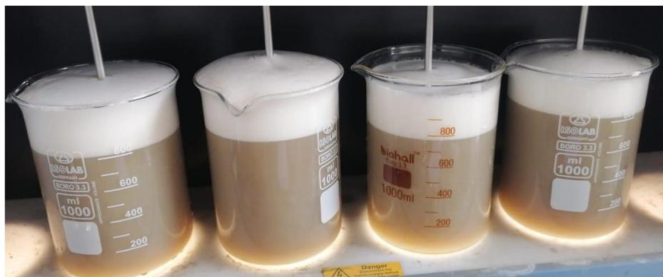
Nota: La imagen muestra la separación del análisis en el test de jarras.
